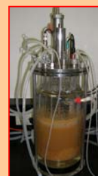
攪拌式發酵槽
